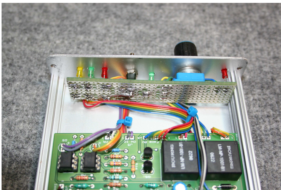
Le circuit de la face avant en place dans le coffret
